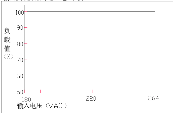
输出负载降额与输入电压关系
